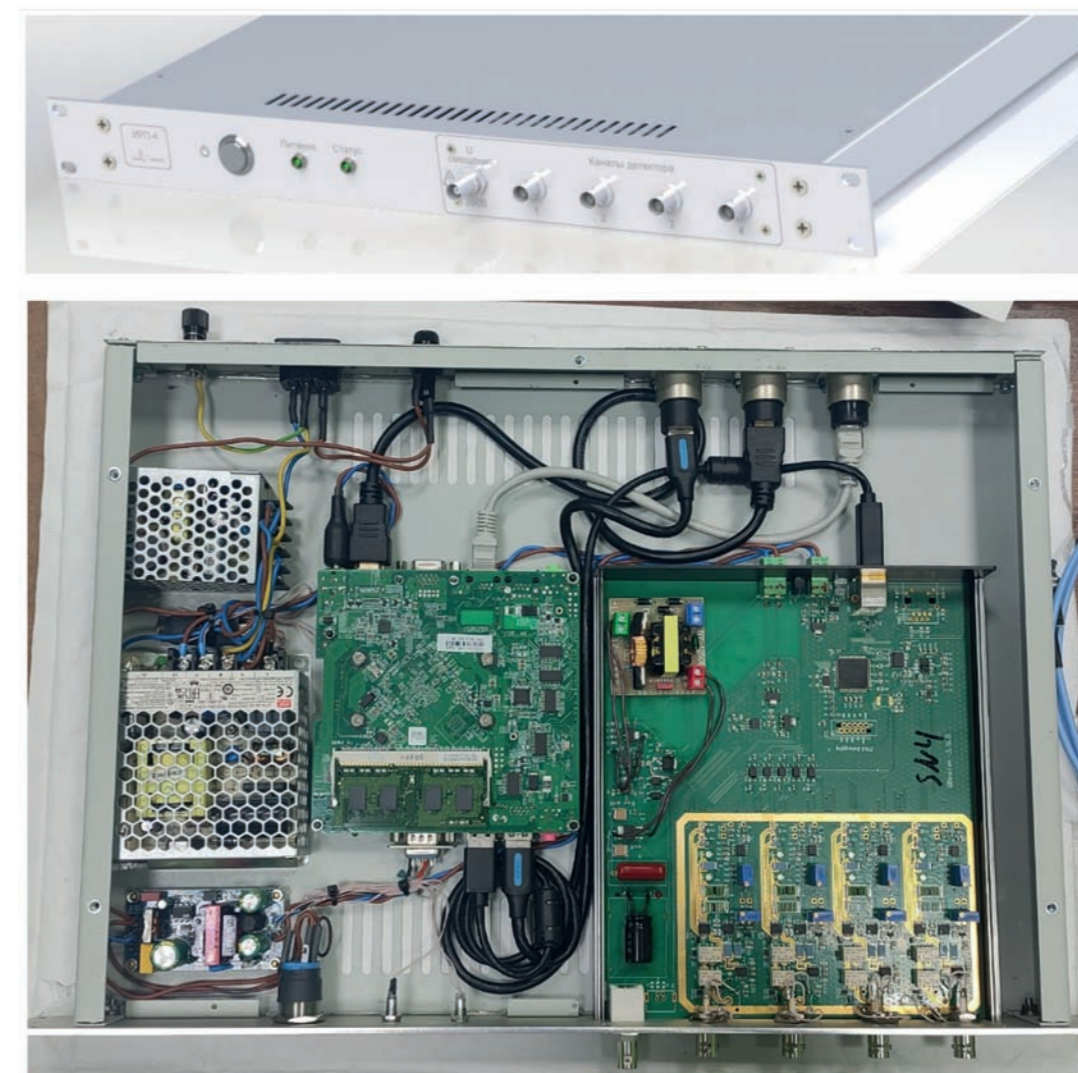
Рисунок 4.10. – Внешний вид и внутреннее устройство блока системы мониторинга пучка
