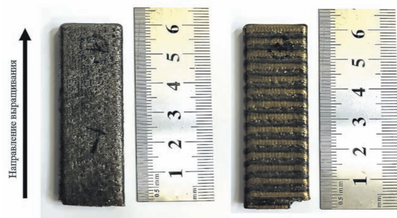
Рисунок 2.6. – Образец из аустенитной стали (слева) образец из функционально-градиентного материала (справа), полученные методом прямого лазерного выращивания, стрелкой обозначено направление выращивания
